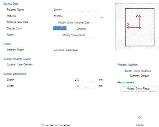
Figura 6. Asignación de sección solera de corona.
