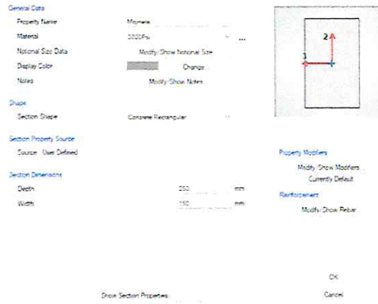
Figura 5. Asignación de sección viga mojinete.
