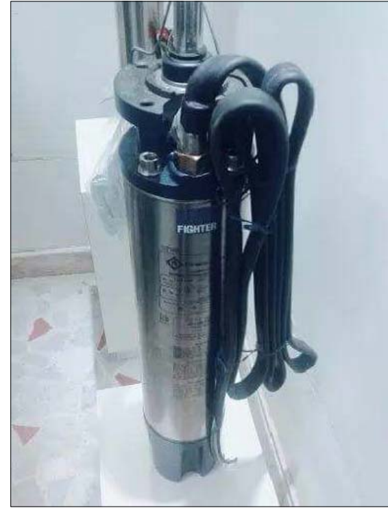
MOTOR SUMERGIBLE V: 460v Trifásico HZ: 60 Kw: 30 r.p.m: 3450
